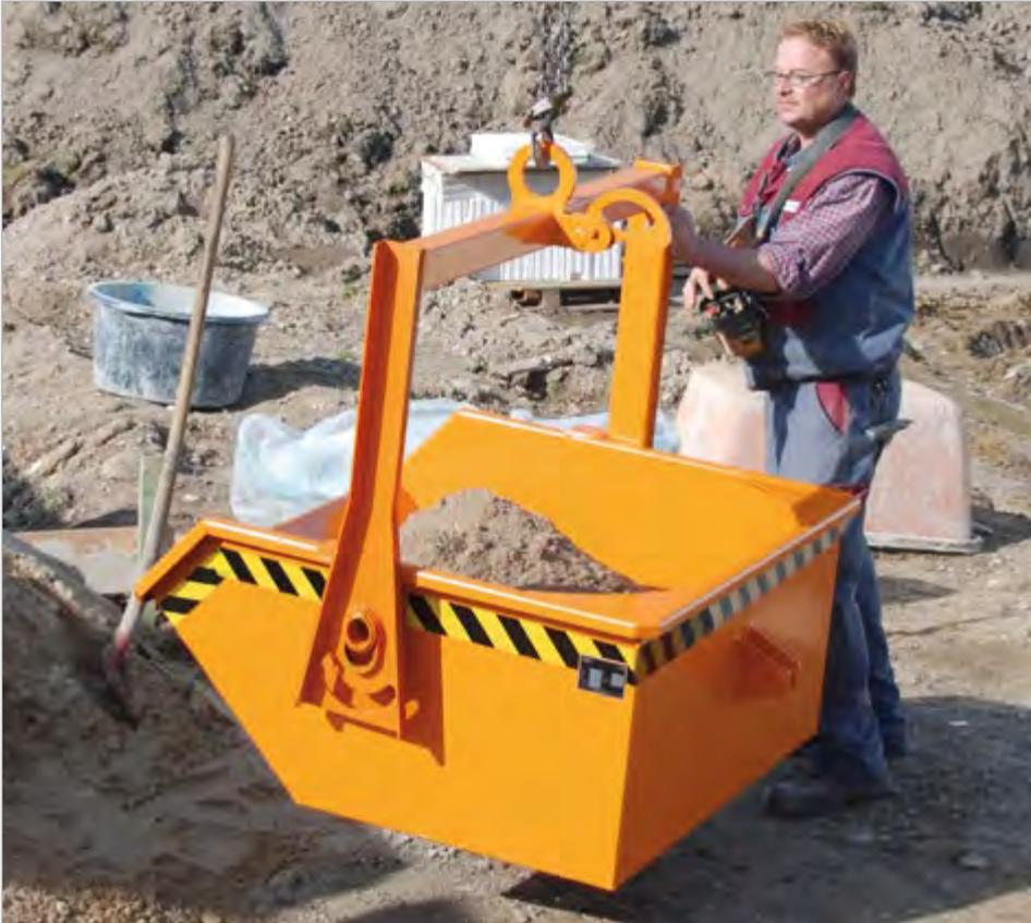
Hervorragend geeignet für Transport und Handling von Materialien auf Baustellen
