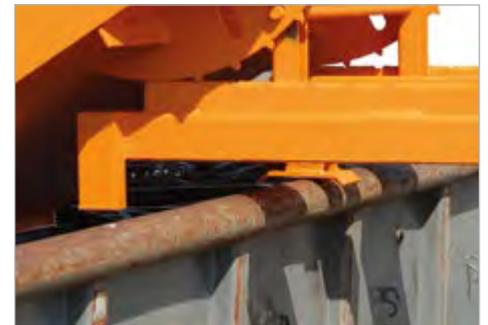
② Manuelle Entriegelung durch Zugseil
