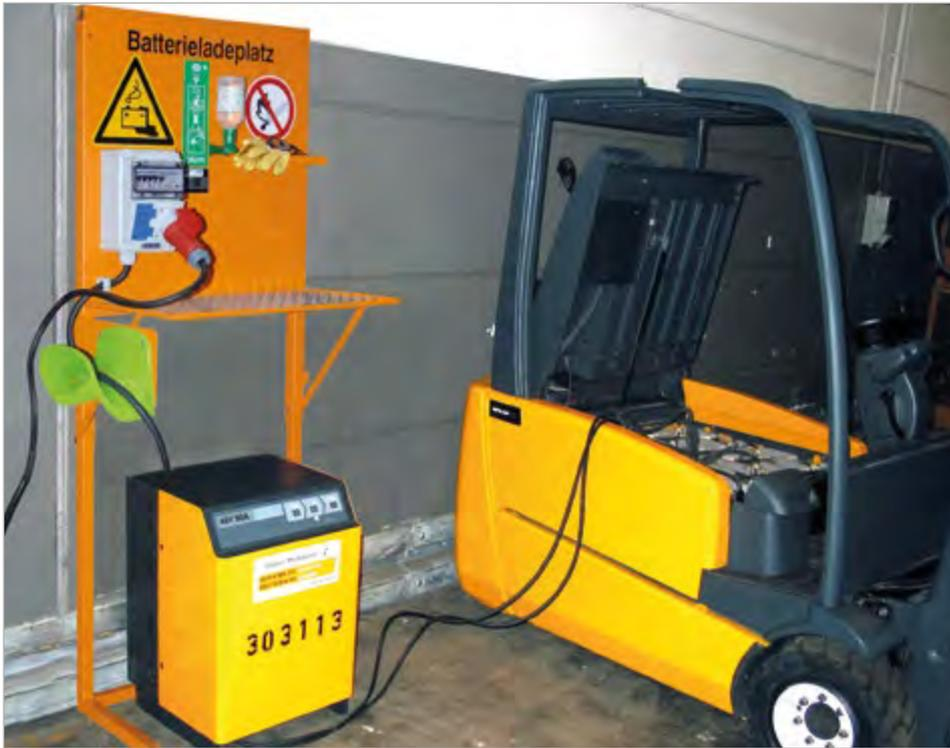
Typ BL mit CEEform Steckdose 400 V beim Aufladen eines Elektro-Gabelstaplers
